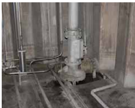
Afb. 2: Ladingtank, damwandprofiel, diepwellpomp en verwarmingsbuizen
